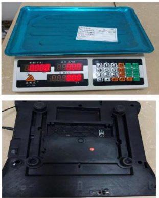
图 2：电子计价秤无铅封、无计量法制标志和计量器具标识
